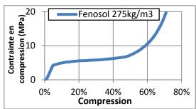
FENOSOL<sup>TM</sup> a de très bonnes propriétés mécaniques. Le rapport de contrainte en compression sur densité est élevé en comparaison avec d'autres matériaux.
