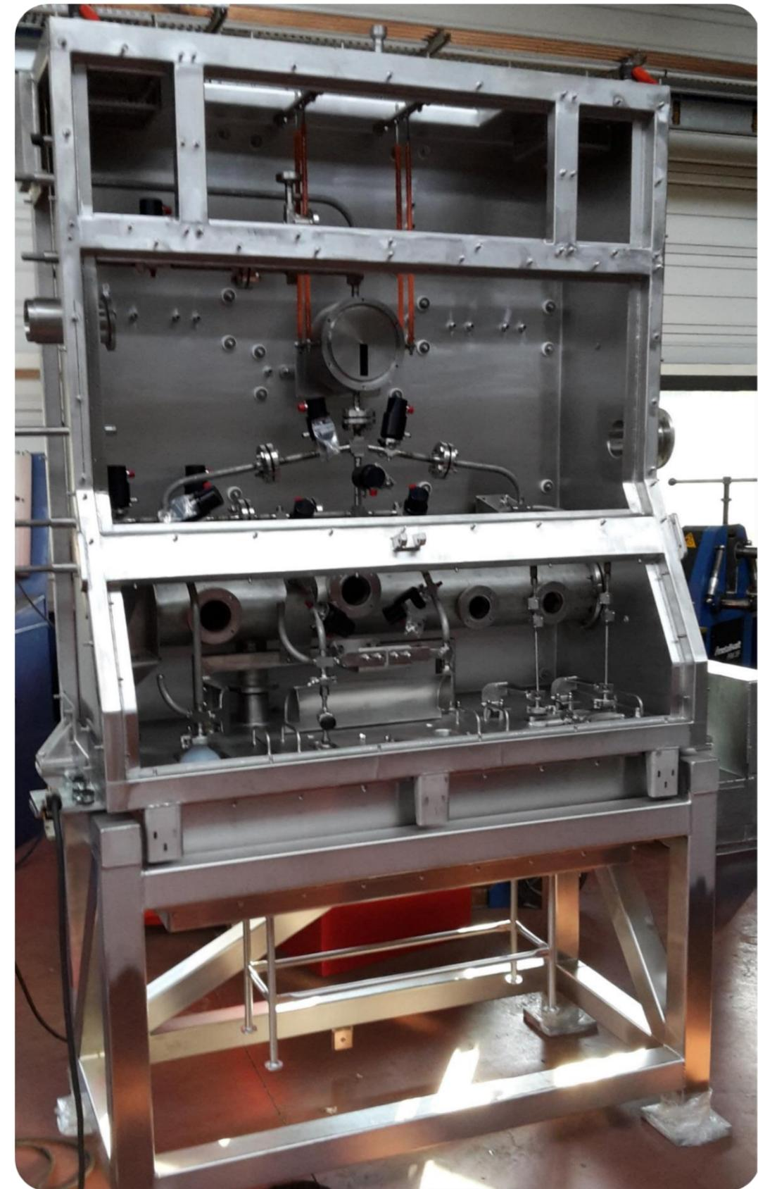
➤ Enceintes de prélèvement – prise d'échantillon d'UF6
