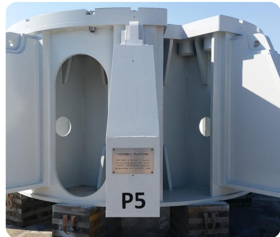
➤ Plateforme de dépose du solénoïde central
