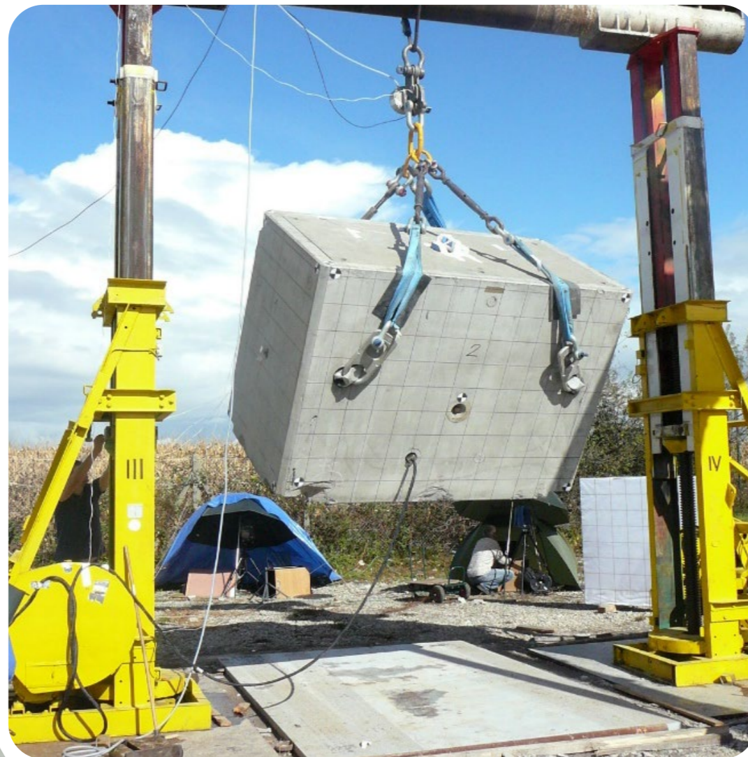
➤ Chute Démonstrateur ANDRA – 14T
