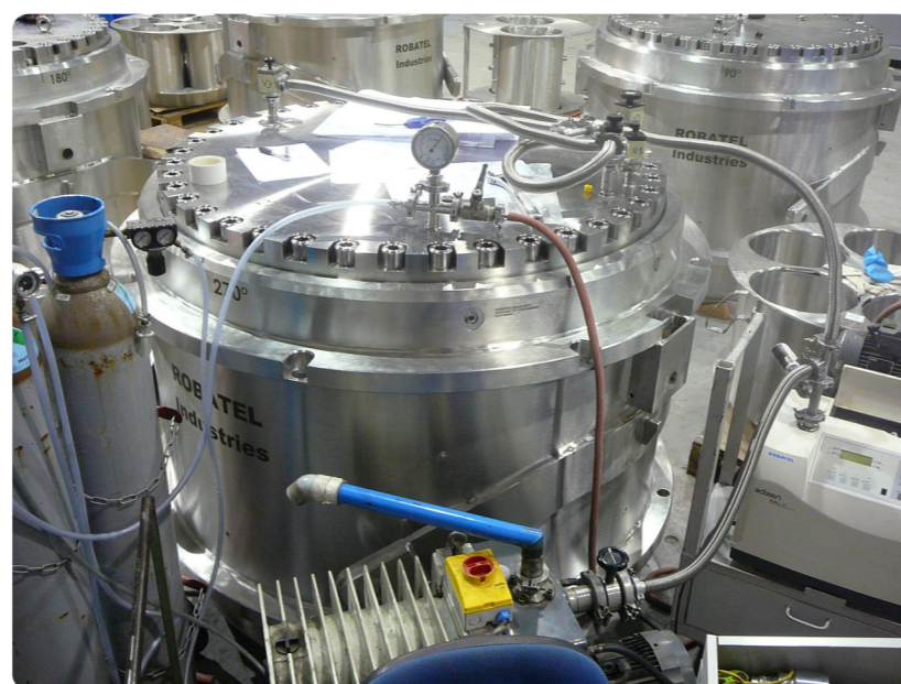
➤ Essais étanchéité emballage R76
