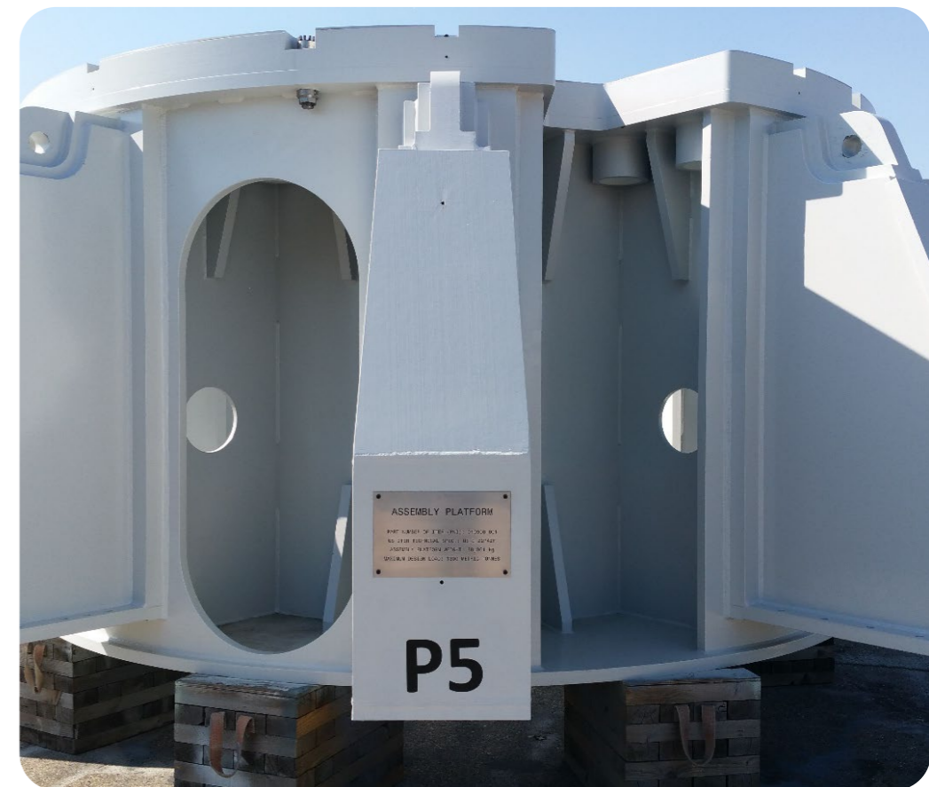
➤ Plateforme de dépose du solénoïde central
