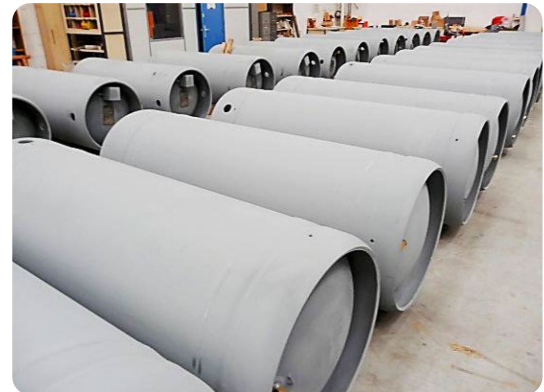
➤ Paniers de stockage combustible
